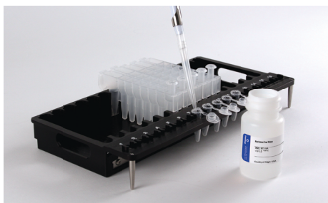
Figura 2. Preparazione e allestimento del vassoio. Nuclease-Free Water viene aggiunta alle provette di eluizione come indicato.
